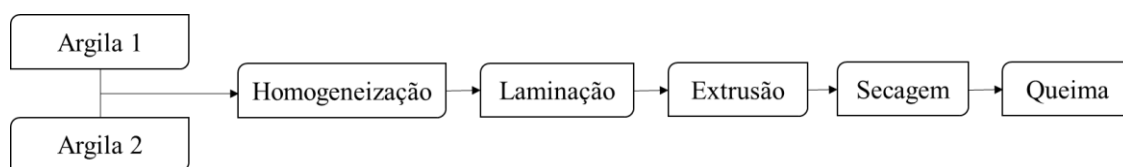
Figura 2 - Esquema do processo de produção de cerâmicas vermelhas.
