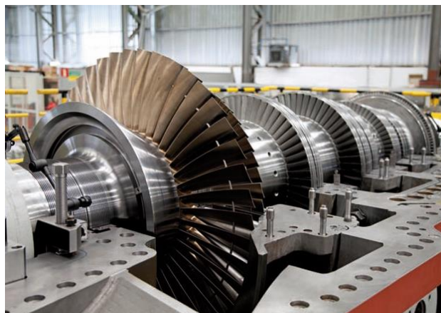
Figura 5 – Exemplo de Turbina a Vapor do tipo composta
