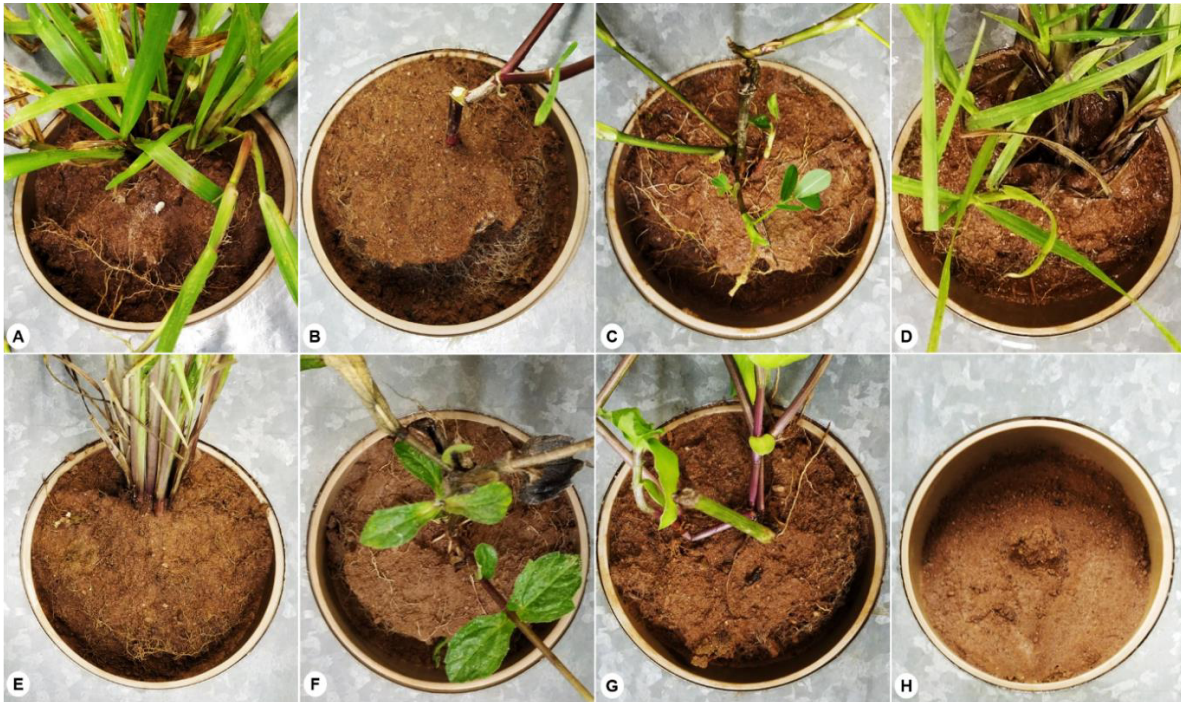
Figura 58 - Amostras logo após submetidas ao ensaio de fluxo concentrado. A: A. affinis ; B: A. philoxeroides ; C: A. pintoi ; D: P. notatum ; E: P. plicatum ; F: S. trilobata ; G: T. diuretica ; H: controle.
