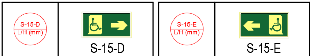
Figura 15 – Sinalização da saída de emergência para pessoas com deficiência, PcD, ou acesso à área de resgate.
