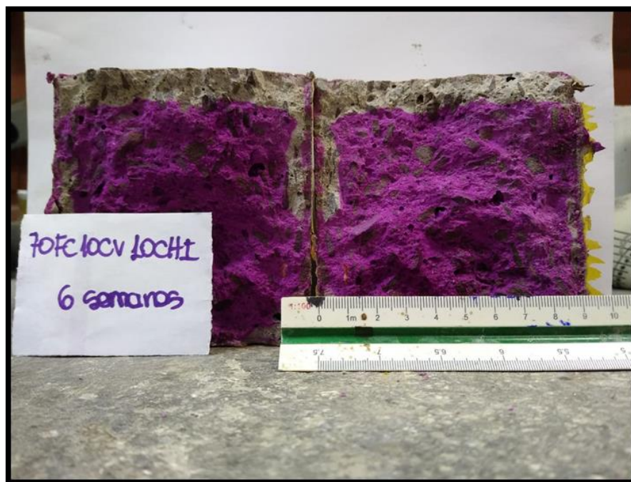
Figura 4.21 – Profundidade de carbonatação acelerada do FC70CV10CH10 com 6 semanas
