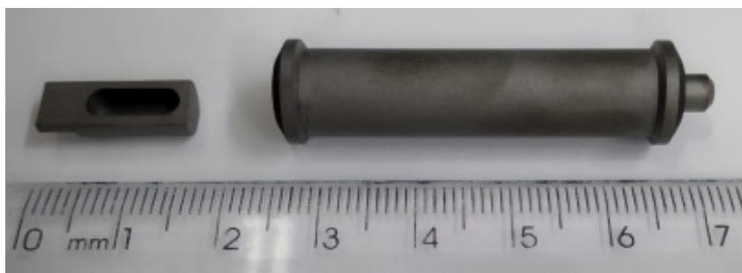
Figura 2 - Plataforma e tubo de grafite utilizado no ETV-ICP-MS.
