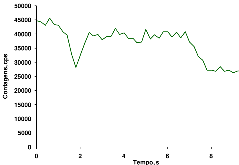
Figura 20 - Efeito da vazão do O 2 sobre a intensidade do Ar 2 + : Condições: 100 mL min -1 de O 2 ; pirólise a 700 °C (40 s); vaporização a 2200 °C (6 s); 0,25 mg de sangue; 6 mg de ácido cítrico; vazão do gás bypass de 0,40 L min -1 ; gás carreador de 0,40 L min -1 e freon de 2,00 mL min -1 .
