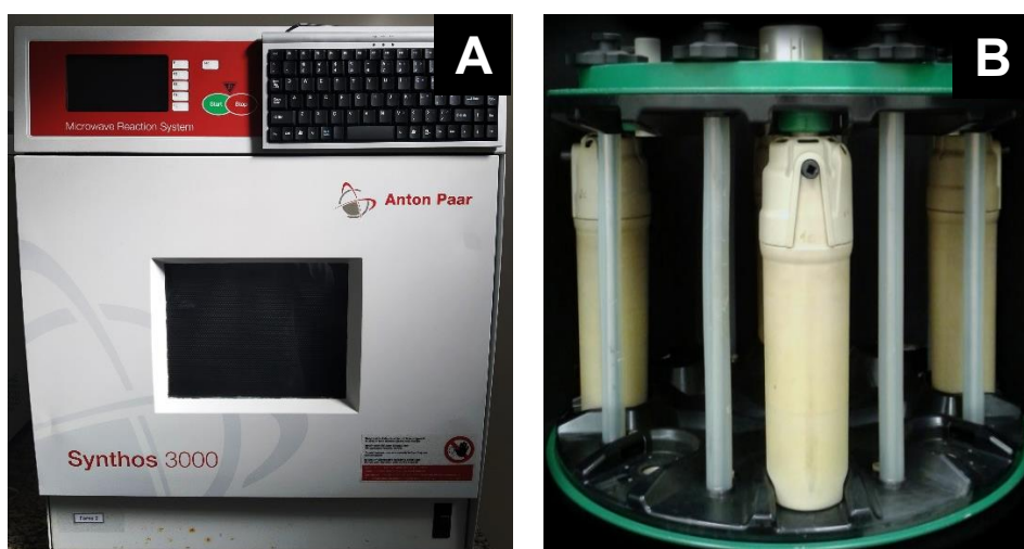
Figura 2 – (A) Forno de micro-ondas Synthos 3000, Anton Paar (B) Rotor equipado com 4 frascos de quartzo, na MIC.
