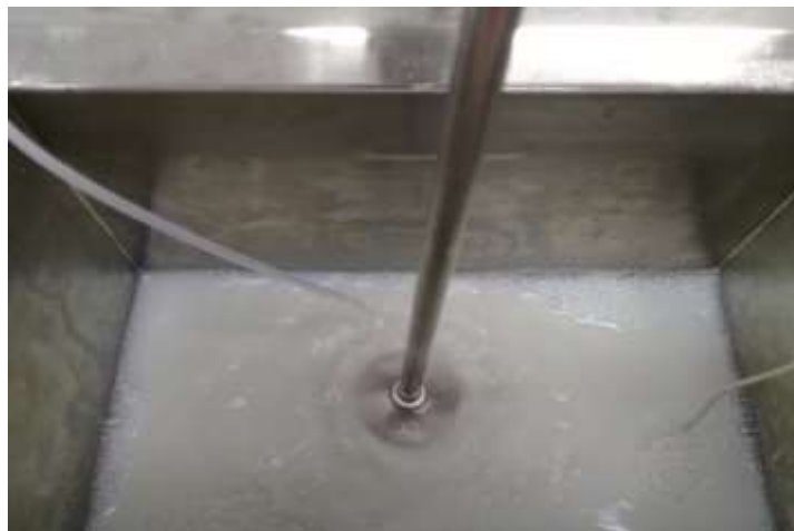
Figura 22 - Sistema utilizado no processo de emulsificação em banho ultrassônico.
