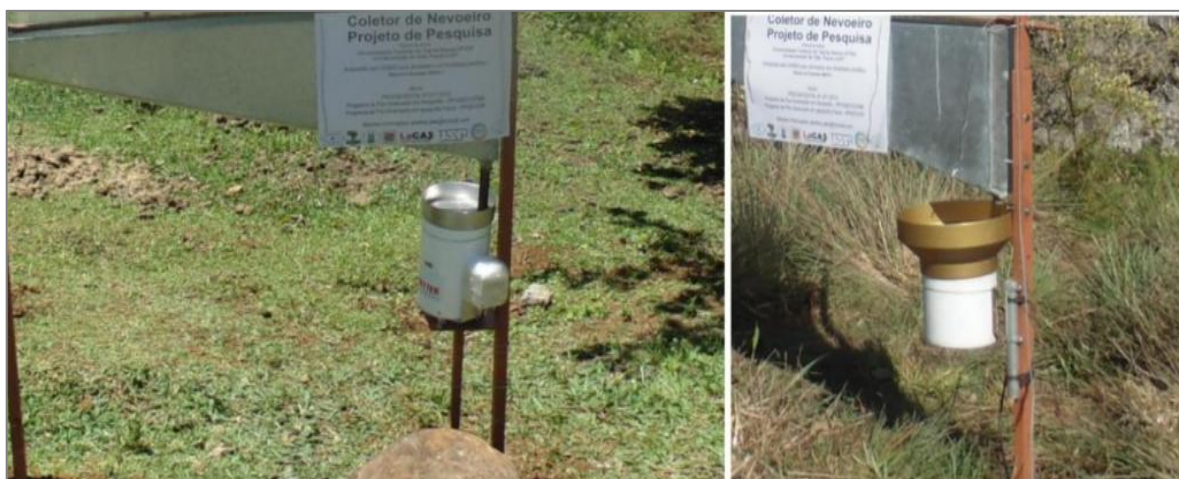
Figura 25: Pluviômetro modelo Squitter S1610 (esquerda) e Pluviômetro modelo TR525-mm (direita) utilizados para a coleta da água dos neveiros.
