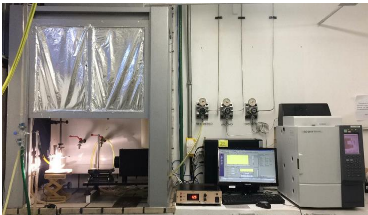
Figura 37. Sistema fotocatalítico para produção de hidrogênio instalado no Laboratório de Materiais Inorgânicos do Departamento de Química da UFSM.
