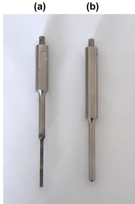
Figura 9 - Sondas de ultrassom utilizados no desenvolvimento do processo de desemulsificação no processador de US de 130 W. (a) sonda modelo 630-0422 e (b) sonda modelo 630-0435.
