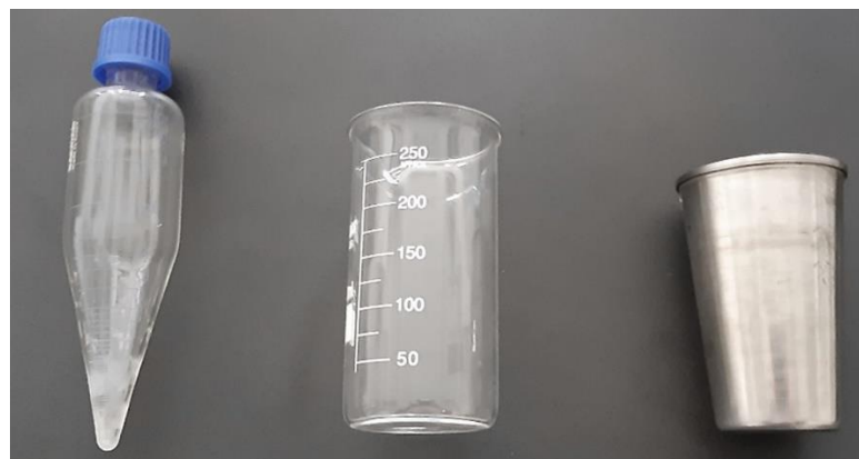
Figura 10 - Frascos separadores utilizados no processo de desemulsificação empregando ultrassom.
