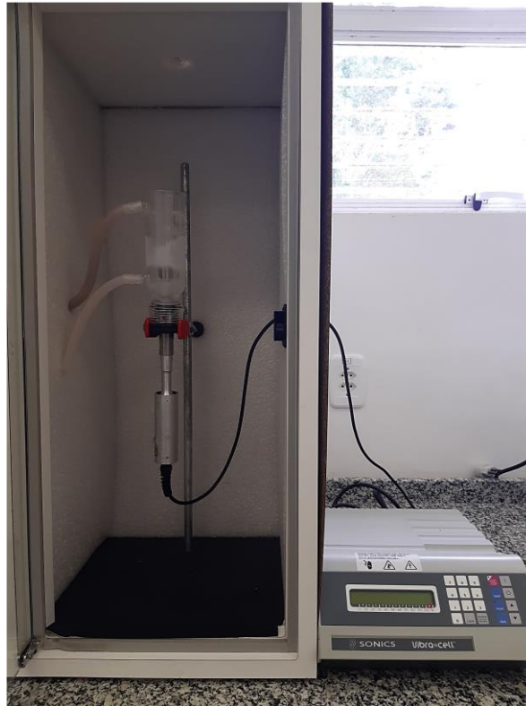
Figura 7 - Sistema de ultrassom: cup horn de 20 kHz de frequência e 130 W de potência nominal.
