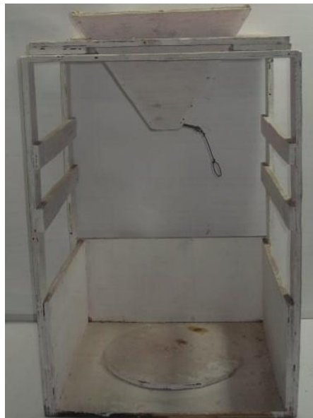
Figura 13 - Dispositivo utilizado para determinar o ângulo de repouso
