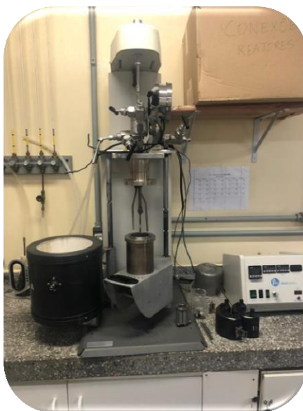
Figura 9 – Reator PARR utilizado nas reações.
