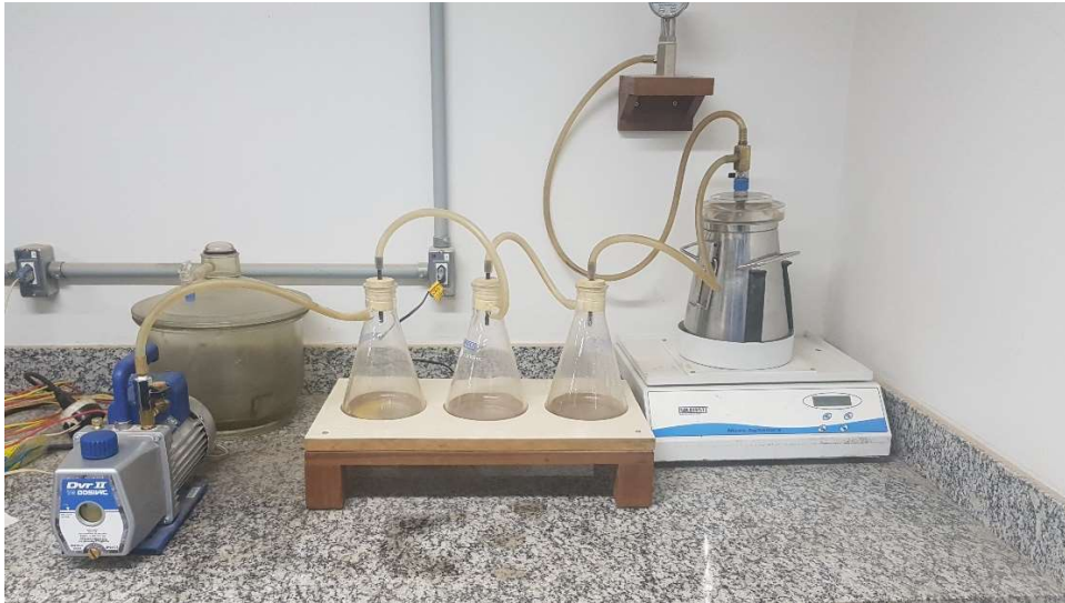
Figura 12 – Montagem do equipamento para execução do teste Rice.
