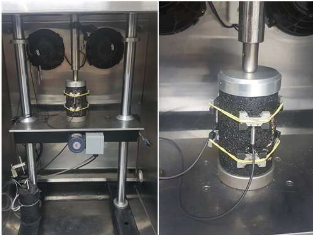
Figura 17 - Ensaio de Módulo Dinâmico a 54°C, com ênfase para a colocação de elásticos ao redor do CP.
