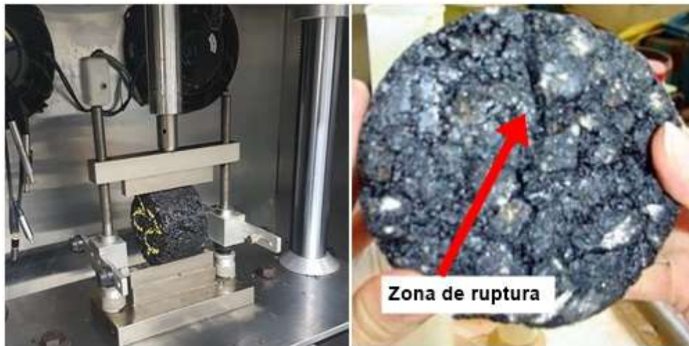
Figura 18 - Equipamento montado para realizar RT e CP rompido.
