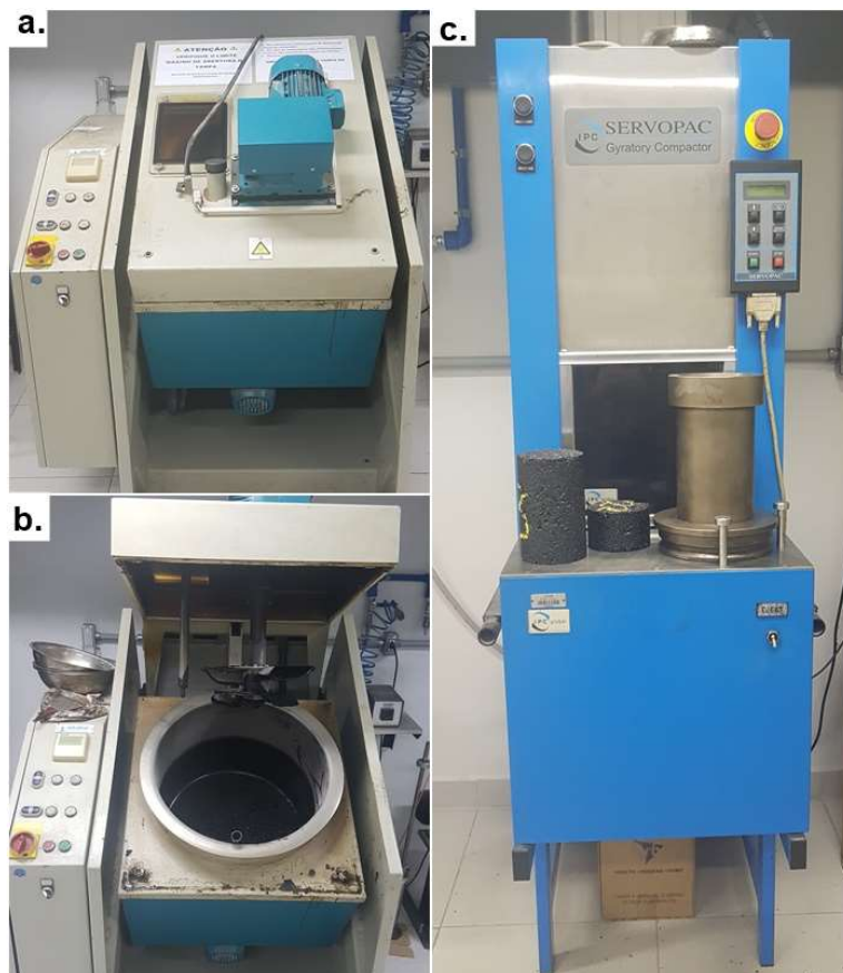
Figura 11 – Misturador Infratest: fechado e aberto com mistura, a. e b., respectivamente. À direita Compactador Giratório Servopac.
