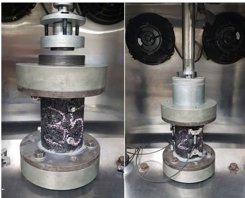
Figura 20 - Aparato do ensaio de Fadiga tração compressão Uniaxial e equipamento pronto para ensaio, com os LVDTs.
