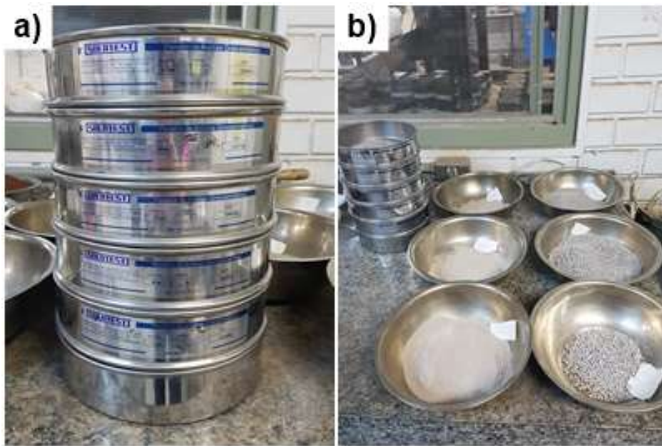
Figura 10 - Em a) Série de peneiras utilizadas para obter o pó de pedra e em b) bandejas com as frações peneiradas.
