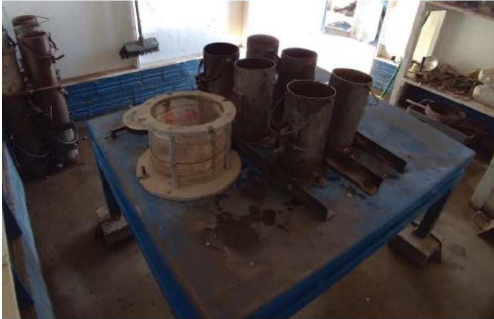
Figura 19 - Consistômetro Vebe Modificado Encaixado à mesa vibratória.
