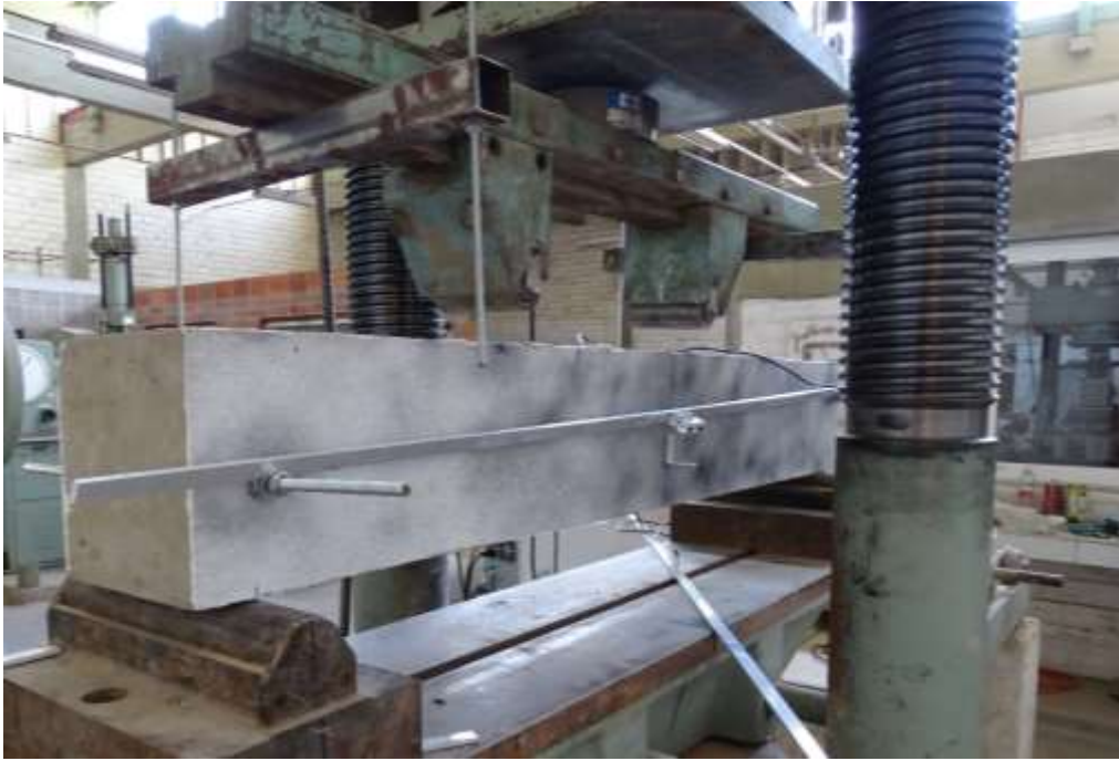
Figura 20: Viga durante a instrumentação.
