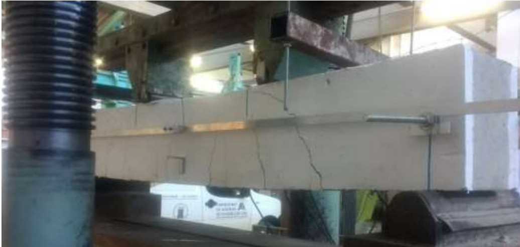
Figura 22: Fissuras na viga, durante o ensaio.
