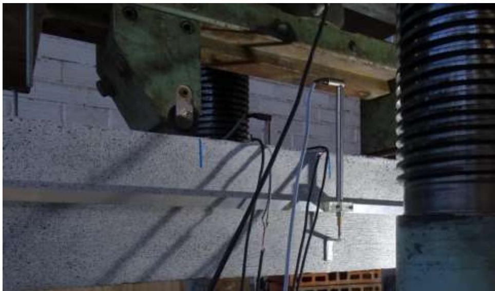
Figura 21: Detalhe do LVDT durante o ensaio.
