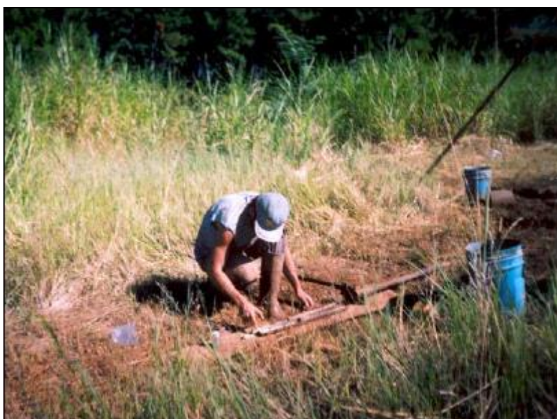
Figura 15 – Amostra de solo sendo analisada e retirada do amostrador padrão
