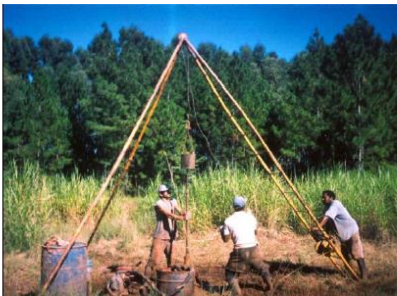
Figura 14 – Execução da sondagem de simples reconhecimento SP-3, coleta de amostras através do amostrador padrão pelo impacto.
