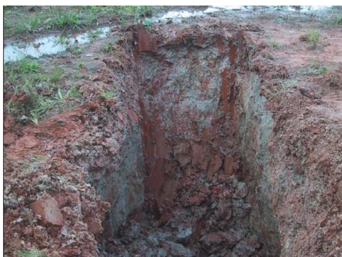
Figura 16 – Detalhe de uma trincheira de amostragem superficial (TS-3)
