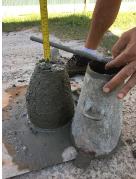
Figura 23 - Medição do Ensaio de Abatimento
