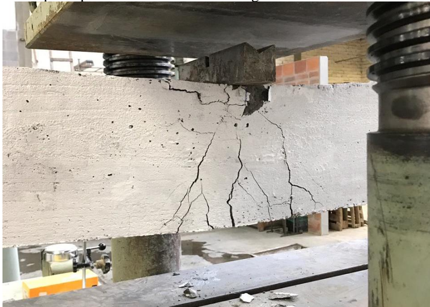
Figura 49 - Ruptura por flexão e concreto esmagado
