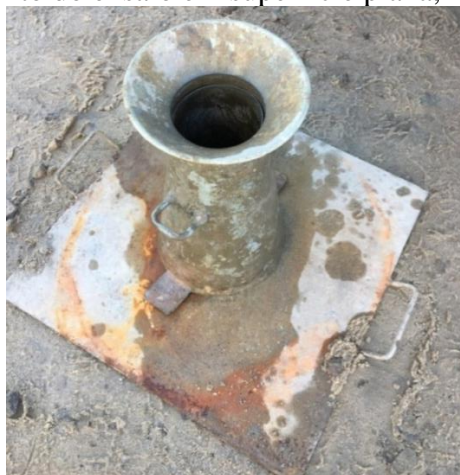
Figura 24 - Aparelhamento do ensaio em superfície plana, horizontal e livre de vibrações
