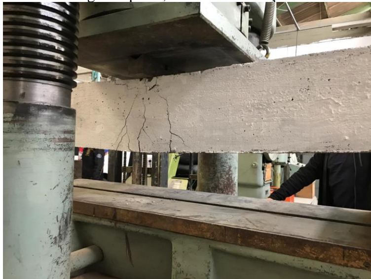
Figura 46 - concreto esmagado após 6,75 toneladas-força
