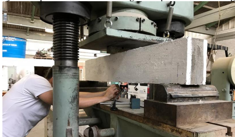
Figura 41: Ajuste do posicionamento do relógio comparador fixado magneticamente
