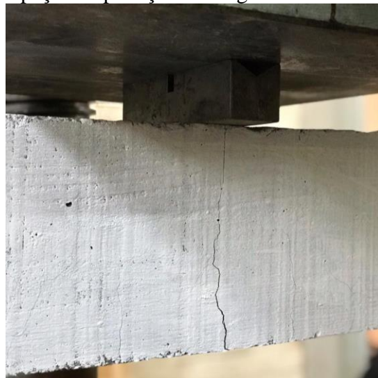
Figura 44 - detalhe da peça de aplicação de carga e fissuras a 90° e 45°
