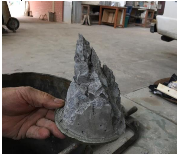
Figura 36 - Tipo B de ruptura
