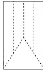
Figura A.2 – Tipo B – Cônica e bipartida e cônica com mais de uma partição
