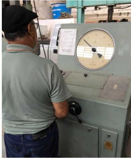
Figura 32 - Central de controle da prensa utilizada no ensaio
