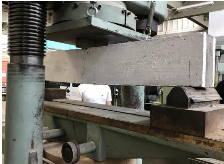
Figura 45 - Fissuras a 90° bem aparentes e deformação após mais de 5 toneladas-força de carga
