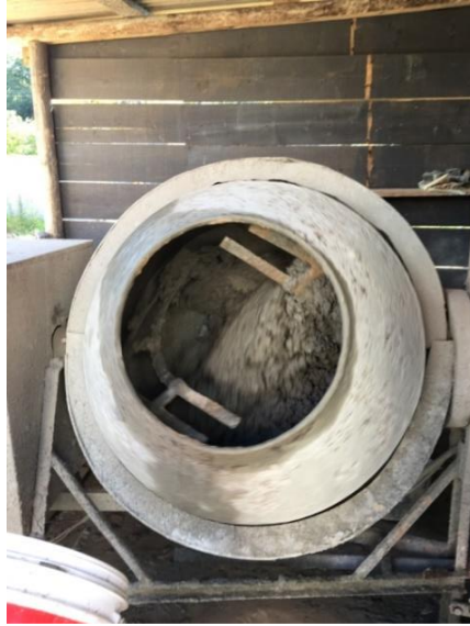
Figura 17 - Betoneira 400 litros trabalhando
