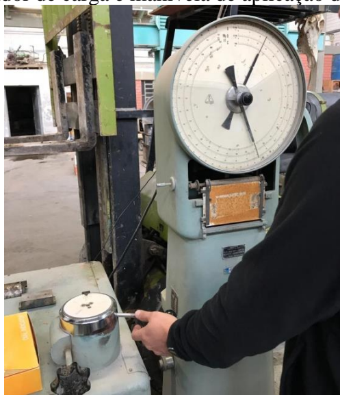
Figura 39 - Relógio medidor de carga e manivela de aplicação de força
