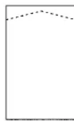
Figura A.7 – Tipo G – Similar ao tipo F com fraturas próximas ao topo
