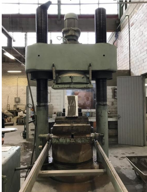
Figura 38 - Prensa utilizada no ensaio de ruptura das vigas
