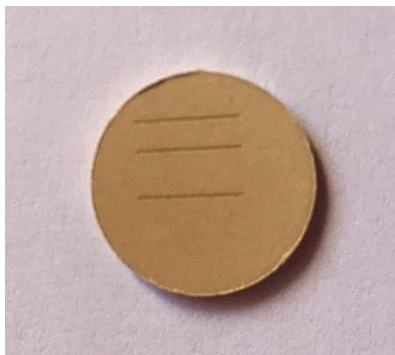
Figura 14 - Foto de um comprimido de amostra após a ablação pelo laser
