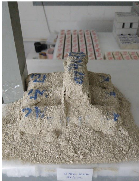
Figura 26. Amostras de 12 MPa submetidas à 900°C e arrefecidas a temperatura ambiente
