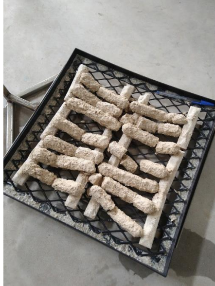
Figura 27. Amostras de 12 MPa submetidas a 900°C após a submersão em água
