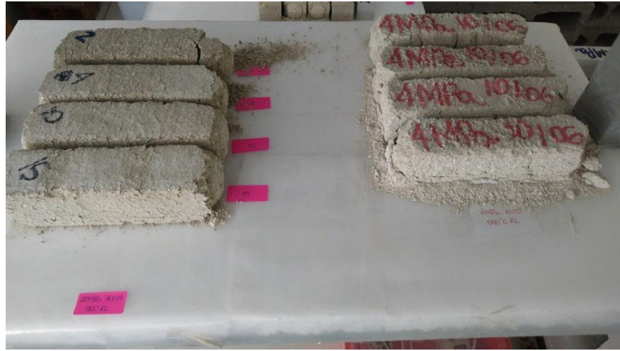
Figura 25. Amostras de 4 MPa e 20 MPa submetidas a 900°C e arrefecidos a temperatura ambiente
