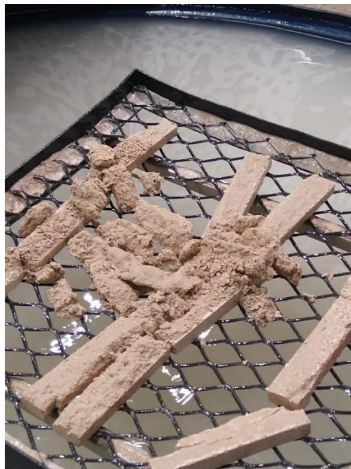
Figura 28. Amostras de 4MPa submetidas a 900°C após a submersão em água
