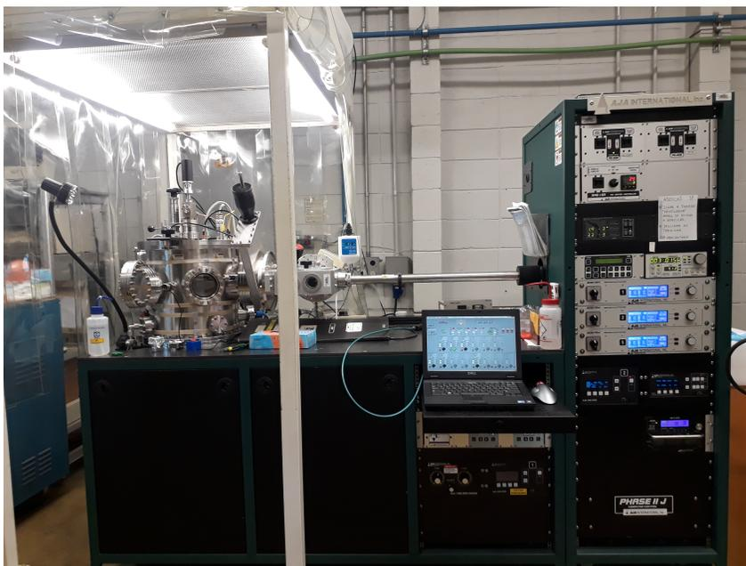
Figura B.2 – Fotografia do *magnetron sputtering* utilizado no crescimento das amostras. Este equipamento pertence ao LMF do CNPEM.
