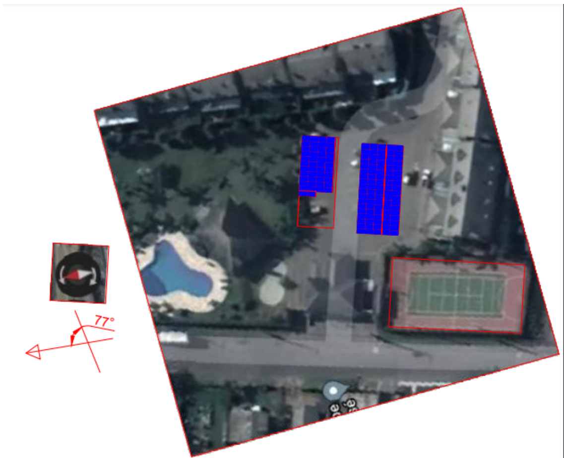
Figura 4.16 – Instalação dos módulos nos estacionamentos.
