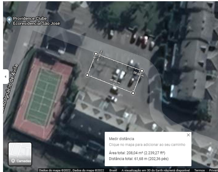
Figura 4.12 – Local e área disponível para instalação dos módulos fotovoltaicos no estacionamento 2
