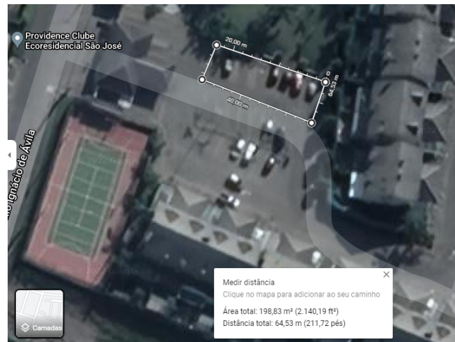
Figura 4.10 – Local e área disponível para instalação dos módulos fotovoltaicos no estacionamento 1
