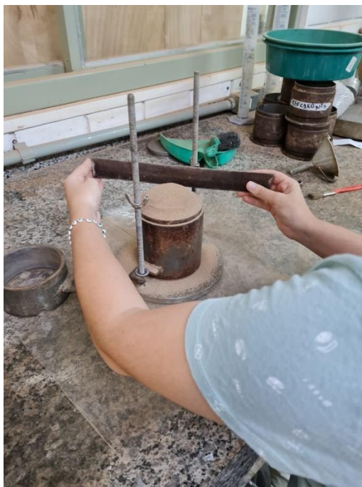
Figura 15 - Preparação do cilindro de Proctor para ensaio
