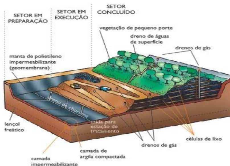
Figura 1 - Esquema do funcionamento de um aterro sanitário
