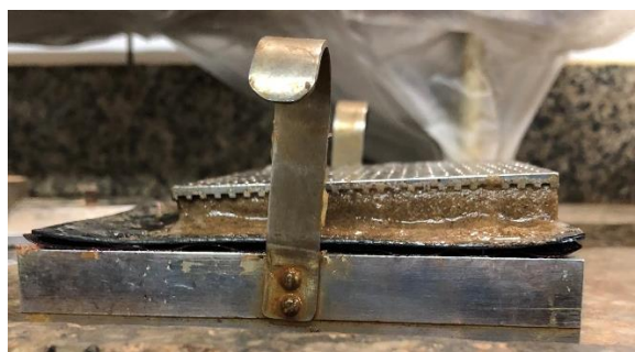
Figura 21 - Corpos de prova cisalhados (a) Interface areia x areia: (b) Interface areia x geomembrana
