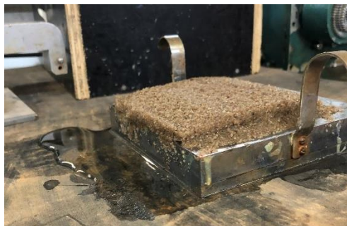
Figura 21 - Corpos de prova cisalhados (a) Interface areia x areia: (b) Interface areia x geomembrana
