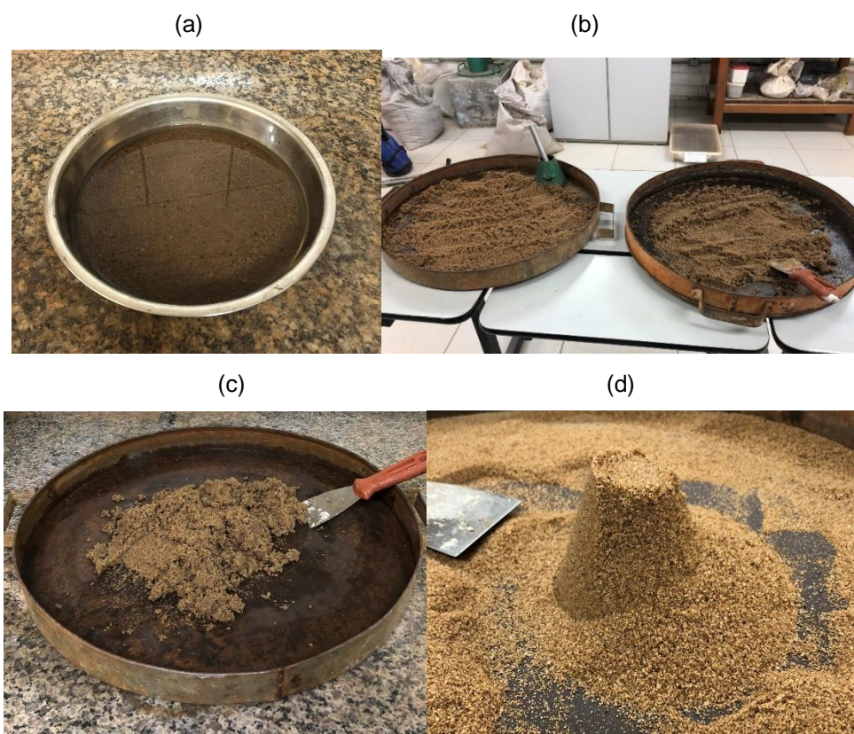
Figura 10 – Preparação da amostra para o ensaio de massa específica: (a) material coberto com água; (b) amostra secando ao ar; (c) amostra sendo revolvida; (d) amostra parcialmente desmoronada
