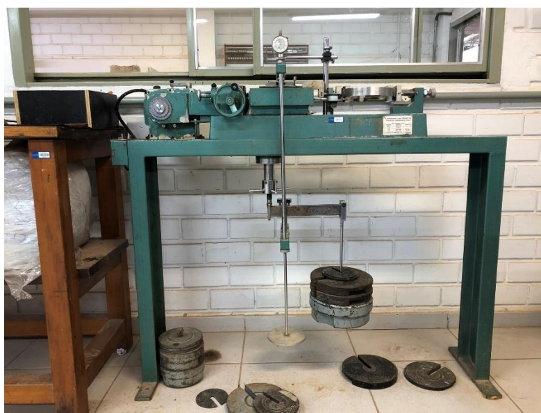
Figura 20 – Aparelho de cisalhamento direto.
