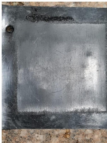
Figura 19 - Geomembrana danificada após ensaio
