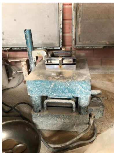
Figura 18 – Mesa vibratória utilizada para preparação dos corpos de prova.
