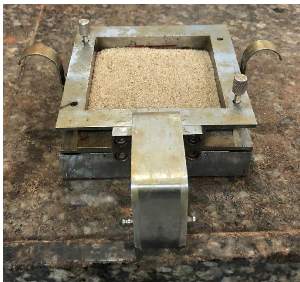
Figura 17 - Corpo de prova preparado para ensaio de cisalhamento direto
