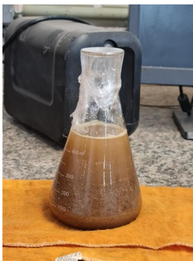
Figura 11 - Areia e água destilada em repouso para o ensaio de massa específica
