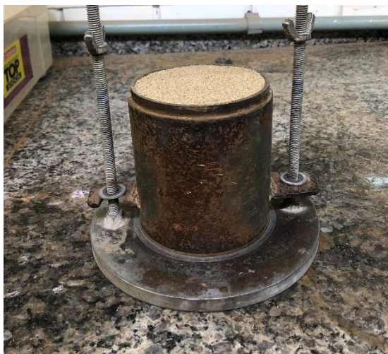
Figura 16 - Cilindro de Proctor preparado para o ensaio
