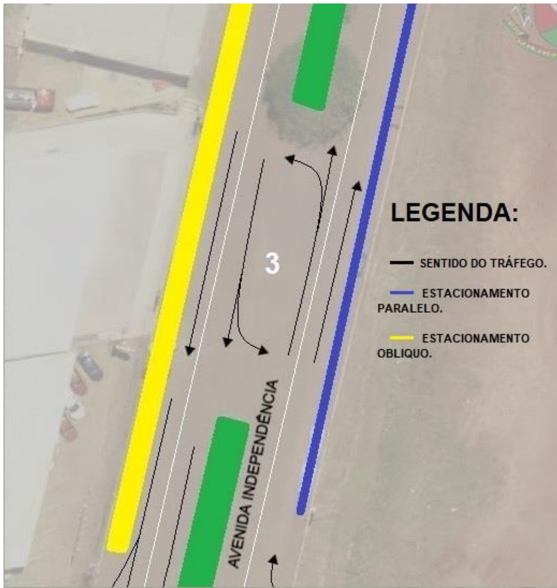
Figura 33 - Ponto de conflito de tráfego na Avenida Independencia.
