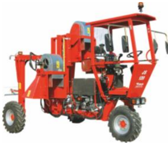
Figura 7 – Máquina para corte, desponte da flor do tabaco comercializada pela empresa Italiana COMANASSISI.
