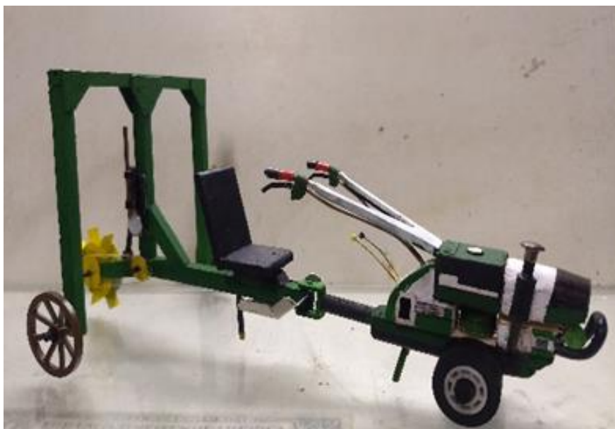
Figura 44 – Modelado em escala 1:10 da alternativa “B” proposto (Mocape).
