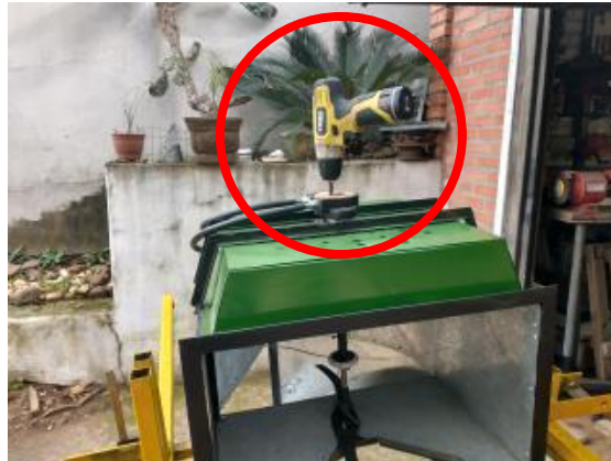
Figura 72 – Furadeira manual a bateria acoplada ao eixo do cortador.
