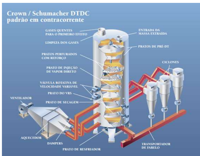
Figura 24 – Modelo do dessolventizador - tostador - secador – resfriador.
