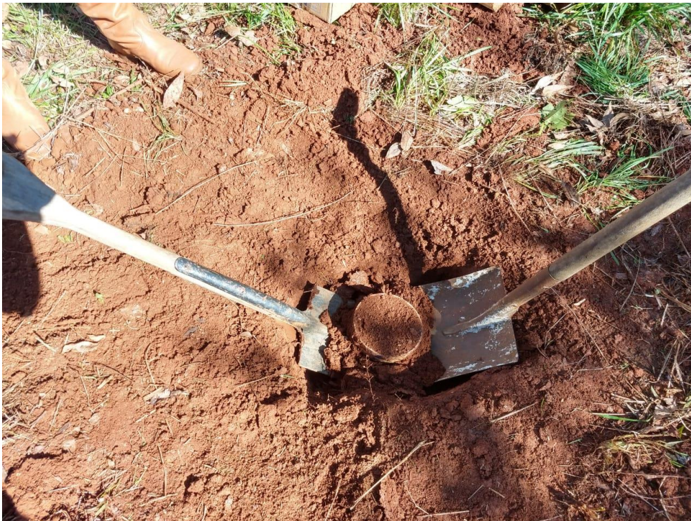
Figura 9 - Coleta de amostra na profundidade de 20-30 cm.
