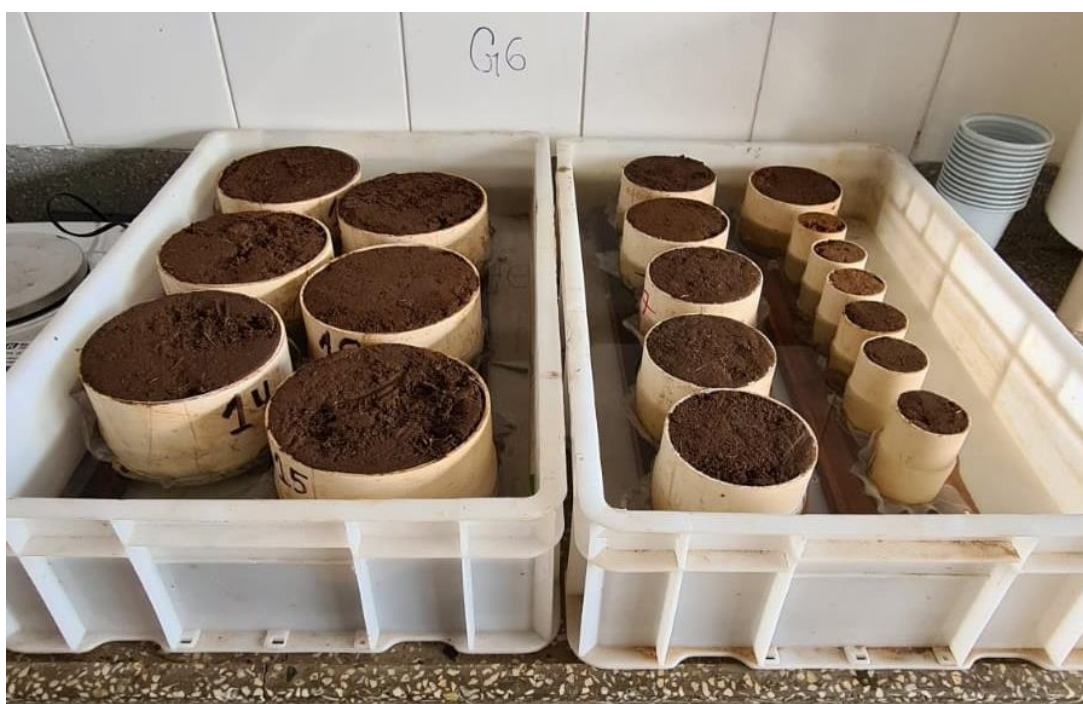
Figura 10 - Processo de Saturação das Amostras
