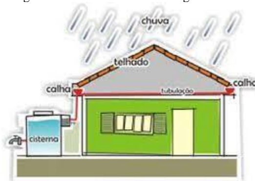
Figura 8 - Sistema de coleta de água da chuva
