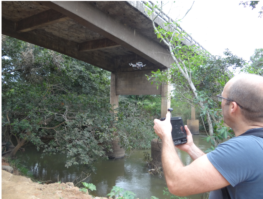
Figura 1.3 – Exemplo de utilização de drone em inspeção de uma ponte
