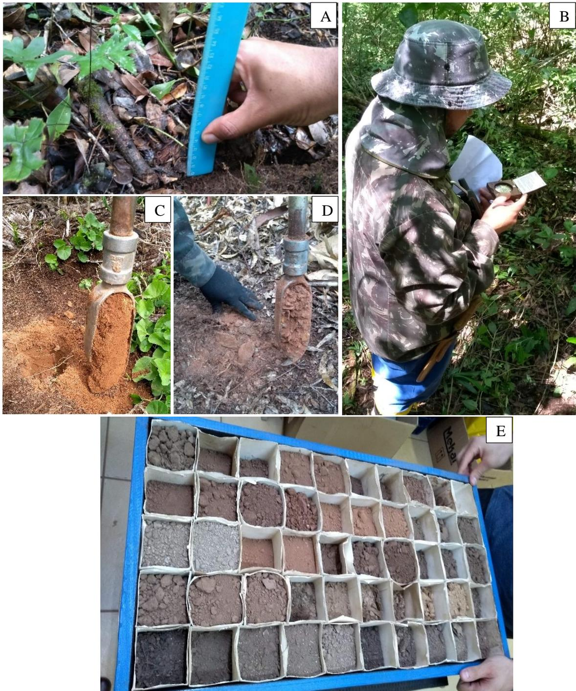
Onde: A) Mensuração da espessura da serapilheira; B) Leitura da abertura do dossel; C) Amostragem de solo em área de plantio de eucalipto; D) Amostragem de solo em área de mata nativa e E) Secagem das amostras de solo para análise do carbono e nitrogênio totais.
