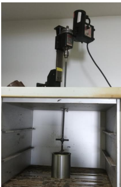
Figura 9 - Parafusadeira adaptada para o procedimento de mistura.
