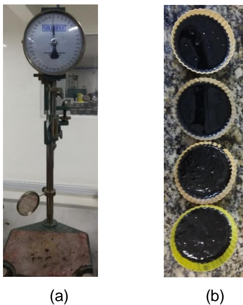
Figura 10 - Ensaio de Penetração. (a) Penetrômetro manual. (b) Amostras do ensaio.
