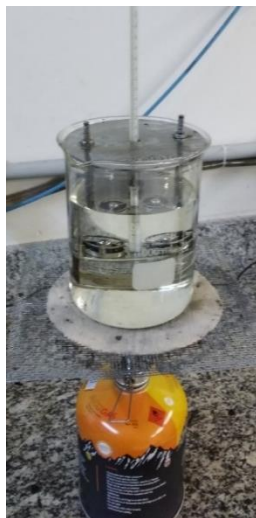
Figura 11 - Ensaio de Ponto de Amolecimento.
