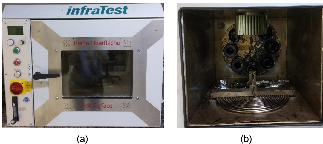
Figura 15 - Estufa de filme fino rotativo (RTFOT) (a) fechada e (b) com as amostras.
