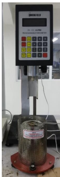
Figura 14 - Viscosímetro Brookfield utilizado na pesquisa.
