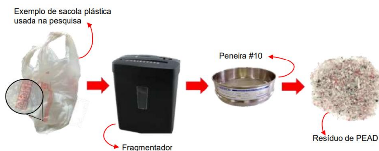
Figura 6 - Processamento do resíduo de PEAD.
