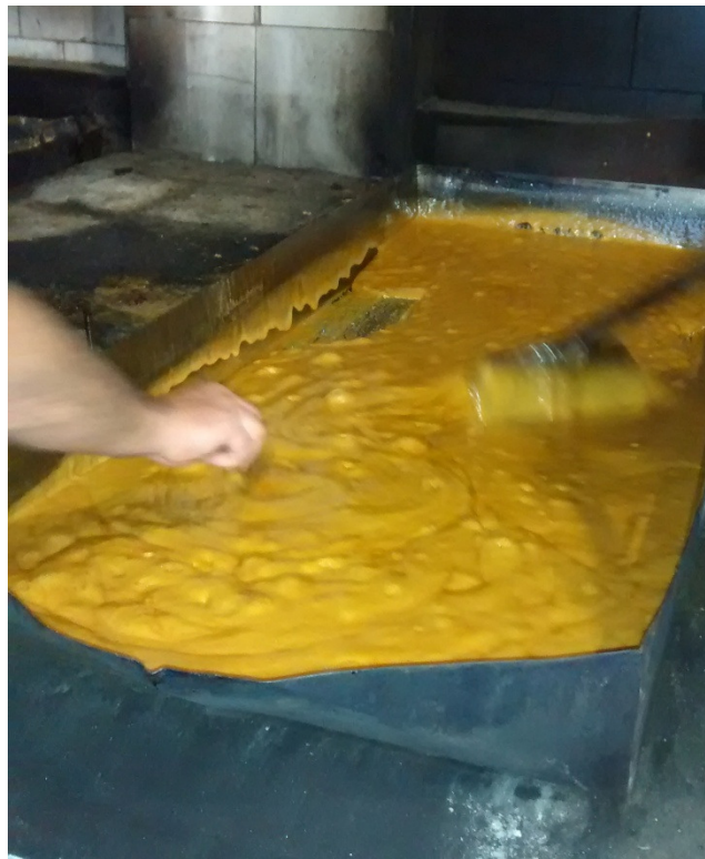
Figura 7 – Massa próxima ao ponto final de concentração para o açúcar mascavo Fonte: Própria
