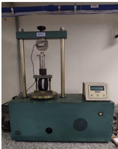
Figura 21 – Dispositivo centralizador para Resistência à tração.
