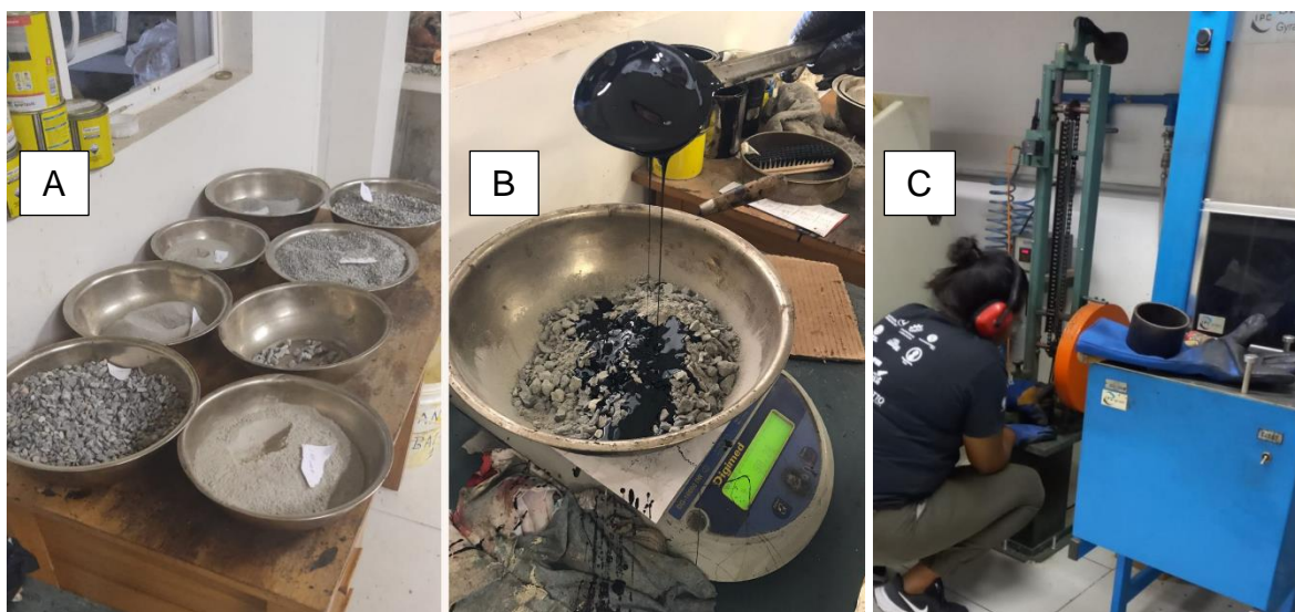
Figura 19 - Material separado em frações (A); adição do ligante (B) e moldagem Marshall (C).
