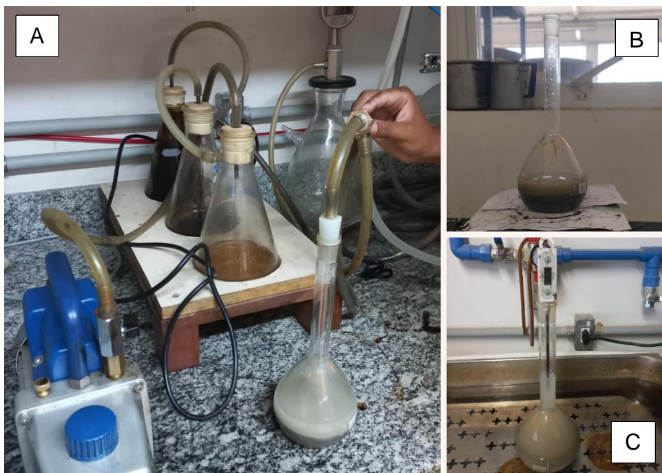
Figura 13 - Ensaio densidade: Picnômetro na bomba de vácuo (A); picnômetro com amostra e água (B) e amostra em banho-maria (C)
