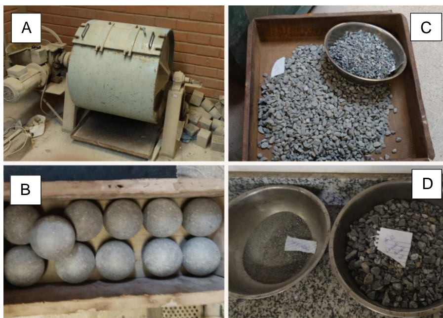
Figura 14 - Ensaio Abrasão: equipamento LMCC (A); bolas de aço (B); material ensaiado (C) e resultado do ensaio (D).
