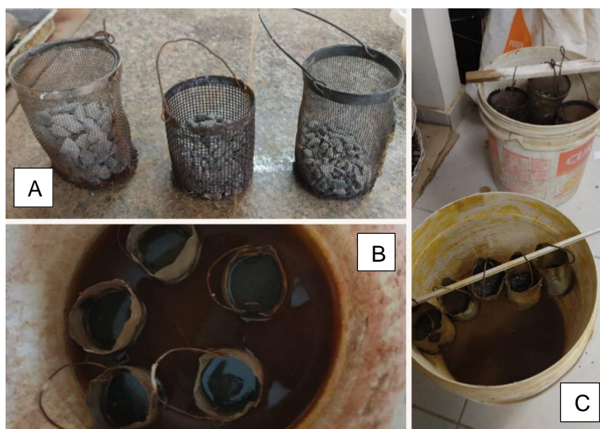
Figura 15 - Ensaio Sanidade: Amostras separadas em frações (A); amostras submersas no sulfato (B) e amostras após 16 horas (C).
