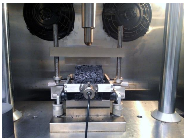
Figura 23 – Ensaio de MR realizado no equipamento UTM-25.
