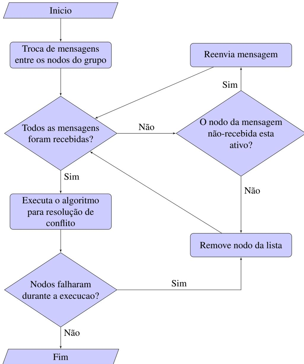
Figura 4.4 – Fluxograma que descreve o algoritmo para resolução de conflitos com suporte de comunicação de grupo
