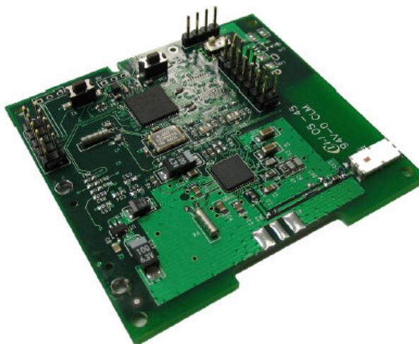
Figura 3.6 – Plataforma XM2400 – Fonte: S3C INC (<http://www.s3cinc.com>)
