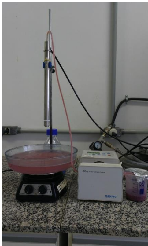
Figura 2 - Produção de micropartículas por gelificação iônica externa
