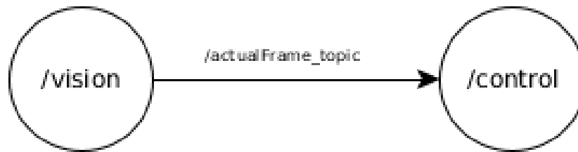
Figura 2.3 – Exemplo de comunicação entre dois nós no ROS.
