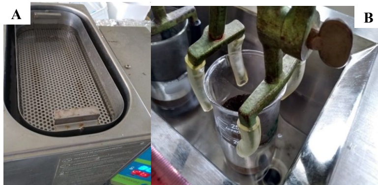
Figura 5 - Banho de ultrassom (A). Extração de compostos bioativos do Ingá por ultrassom (B).
