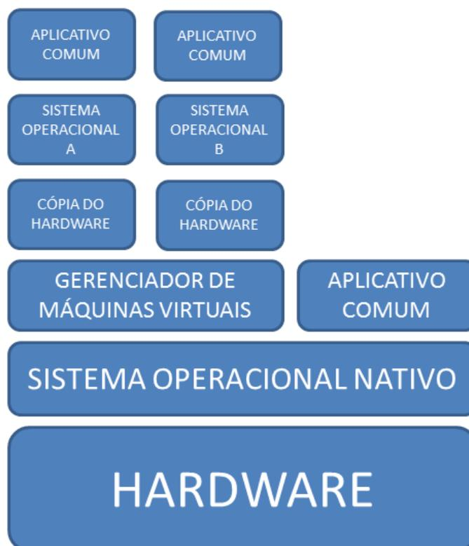
Figura 2-4: Representação das camadas de *software* das máquinas virtuais.
