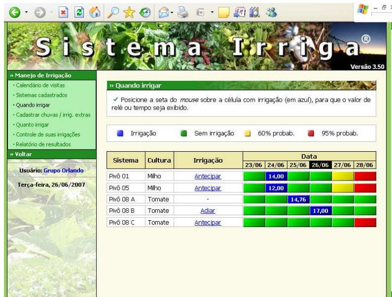
Figura 2.2: Captura da interface do Sistema Irriga disponível aos usuários irrigantes, indicando quando e quanto irrigar para cada sistema de irrigação cadastrado (CARLESSO; PETRY; TROIS, 2007)
