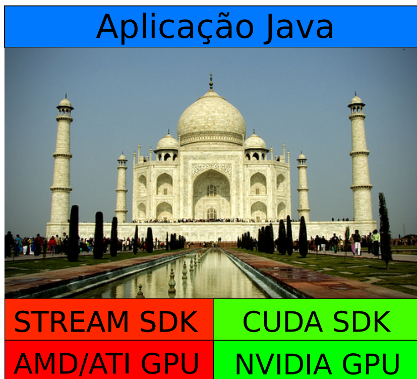
Figura 4.1: TAJMAHAL, funcionando como uma camada intermediária, permite que aplicações Java realizem computações em GPUs.
