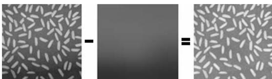
**Figura 4:** Correção de vignetting por subtração do padrão de iluminação gerado por desfoque gaussiano.
