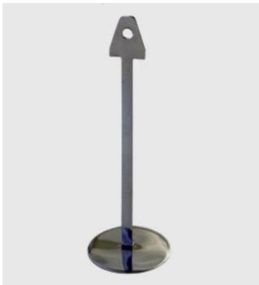
Figura 19 – Porta peso padrão de uma bancada didática
