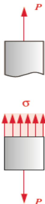
Figura 1 - Tensão na área A da barra submetida a uma carga axial P
