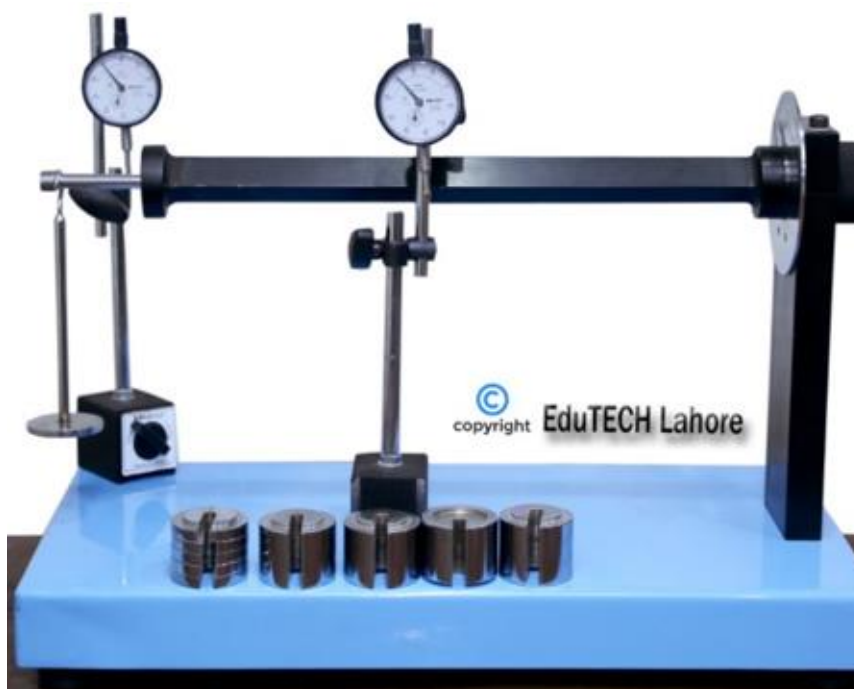
Figura 13 – Bancada didática para viga engastada
