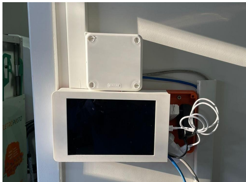
Figura 31 - Raspberry pi com Home Assistant em caixa própria
