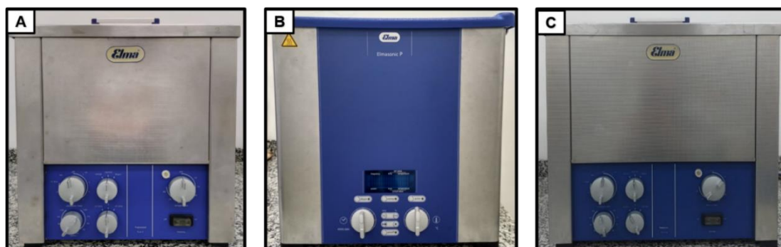
Figura 7 - Banhos ultrassônicos com frequências de a) 25 e 45 kHz; b) 37 e 80 kHz e c) 35 e 130 kHz.
