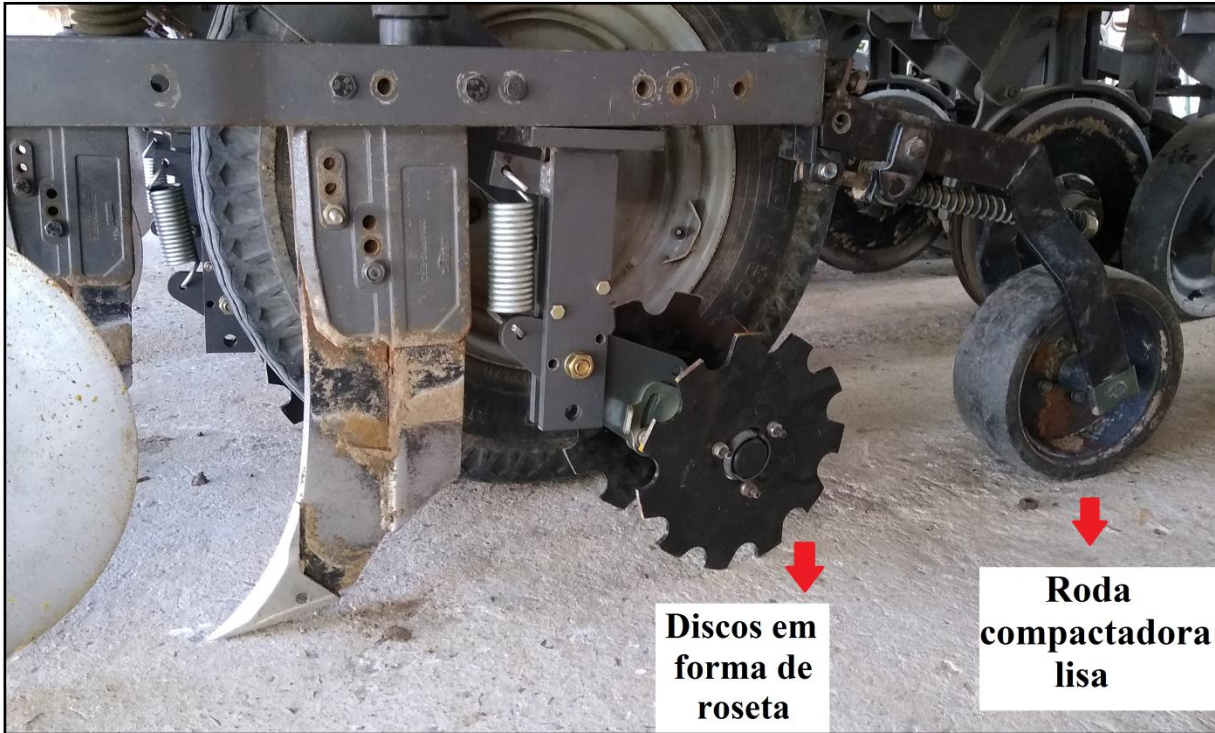
Figura 2 - Detalhe do mecanismo de acomodação do solo desenvolvido pelo Grupo de Pesquisa em Arroz Irrigado e Uso Alternativo de Áreas de Várzea (GPAI) da Universidade Federal de Santa Maria. Santa Maria, RS. 2021
