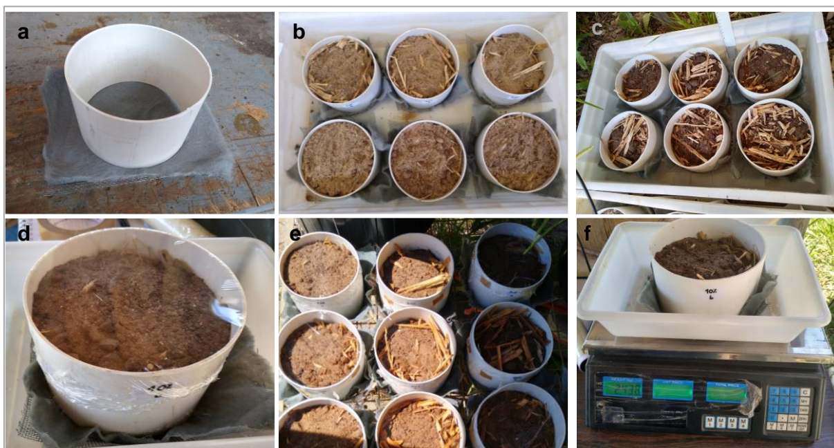
Figura 23 – Teste de proporção de bagaço de cana-de-açúcar em pequenas colunas
