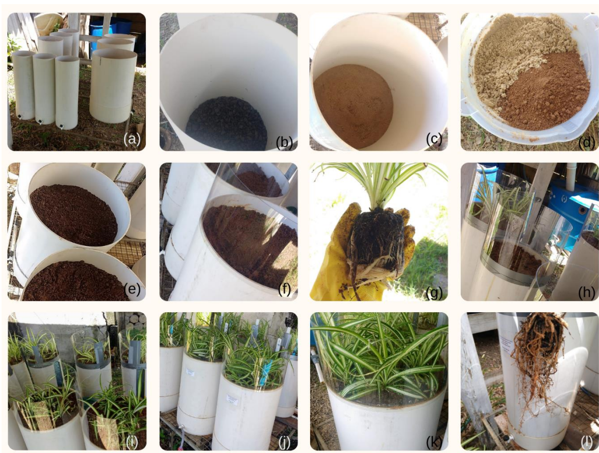
Figura 13 – Montagem do experimento: (a) colunas de diferentes diâmetros, (b) preenchimento da camada drenante, (c) preenchimento da camada de transição, (d) mídia filtrante, (e) preenchimento com a mídia filtrante, (f) prolongamento superior transparente, (g) vegetação a ser transplantada, (h) transplântio da vegetação, (i) vegetação recém transplantada, (j) e (k) vegetação estabelecida, e (l) raízes da vegetação após finalização dos experimentos
