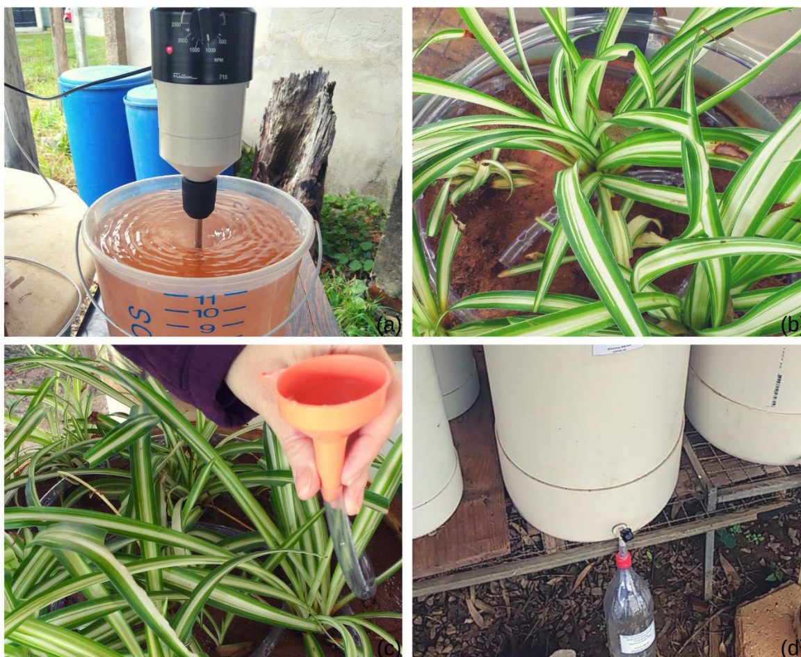
Figura 14 – Procedimento experimental: (a) Escoamento pluvial sintético, (b) mangueira perfurada abaixo da vegetação, (c) funil utilizado nas mangueiras para a aplicação do escoamento pluvial sintético, e (d) reservatório do efluente das colunas
