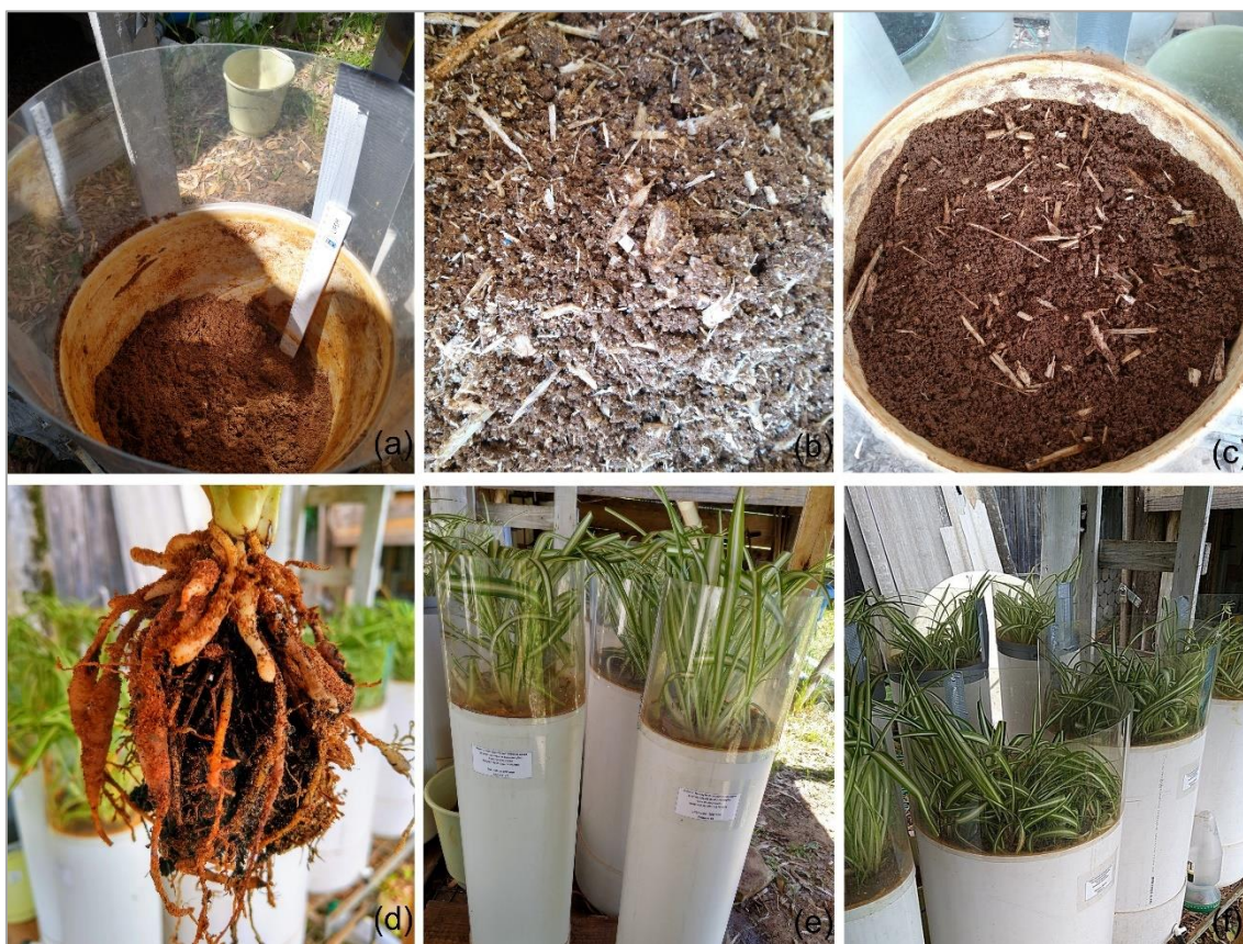
Figura 25 – Montagem das biorretenções com bagaço de cana-de-açúcar: (a) preenchimento da camada de mídia filtrante, (b) mídia filtrante com bagaço de cana-de-açúcar, (c) colunas preenchidas com mídia filtrante com bagaço de cana-de-açúcar, (d) vegetação a ser transplantada, (e) montagem das colunas finalizada e (f) vegetação estabelecida.
