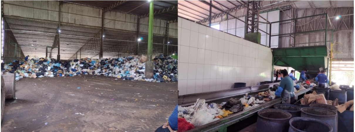
Figura 17 - Ambiente de descarga e esteira de triagem dos RSU.
