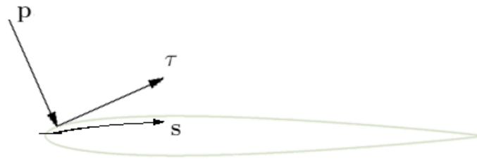
Figura 3.3 – Pressão e tensão de cisalhamento na superfície de um perfil aerodinâmico.
