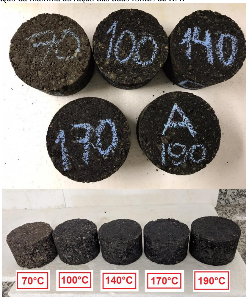
Figura 164 – Amostras compactadas após condicionamento em temperaturas de 70 a 190°C para determinação da máxima ativação das duas fontes de RAP
